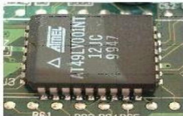
BIOS TIPO PLCC SOLDADA EN MAINBOARD
